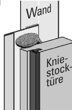
In den Ecken abschneiden und neu ansetzen. Für dichten Anschluss Stöße in den Ecken stauchen.
