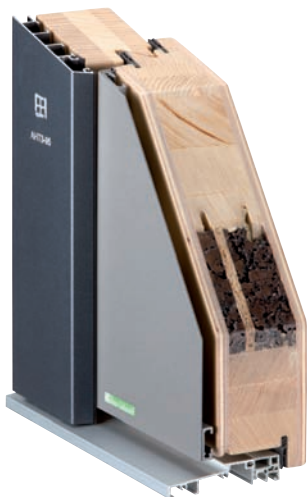
Musterecke AHT 3-95 Flügel aufschlagend (Flügel innen und außen flächenversetzt)
