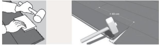
Sie das Anfangsstück angewinkelt in die lange Seite der bereits liegenden Reihe ein und verriegeln es durch sanftes Herunterklappen. Das nächste Element wird ebenfalls zuerst an der Längsseite eingewinkelt und beim Herunterklappen am Kopfende passgenau verriegelt.
