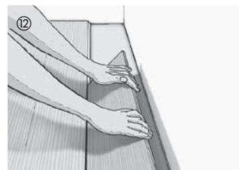
Nach Fertigstellung der gesamten Fläche werden die beiden ersten Reihen wieder entfernt und ohne Klebeschuttfolie wie in Punkt 8 und 9 beschrieben verlegt.
