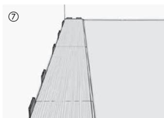
Bevor weitere Reihen verlegt werden, muss nun die exakte Flucht der ersten beiden Reihen überprüft werden. Sie sollten korrekt ausgerichtet sein und der Randbereich unbedingt mit Abstandskeilen fixiert werden. Bei Bedarf kann im Längskantenbereich noch leicht mit dem Schlagklotz nachgeklopft werden.
