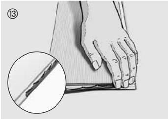
Zuvor muss jedoch die entnommene Feder (siehe Punkt 4) wieder in die stirnseitige Verbindung eingesetzt werden. Achten Sie beim Wiedereinsetzen auf die nach oben zeigende Fase der Kunststofffeder. Das „Doppelschiffchen“ der Feder (siehe Detaildarstellung) zeigt bei richtiger Positionierung zur Federlängsseite.
