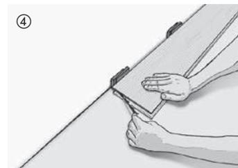
Die Elemente der beiden ersten Reihen werden **zunächst ohne Entfernen der Klebeschuttfolie** verlegt, nach Fertigstellung der Fläche demontiert und erst dann ohne Klebeschuttfolie verlegt. Zu ihrer späteren Demontage ist es nötig, die Kunststofffedern aus den Stirnseiten zu entfernen und aufzubewahren.
