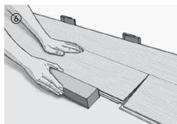
Zur Verlegung der weiteren Elemente der zweiten Reihe (**ebenfalls mit Klebeschuttfolie**) werden die Dielen zuerst längsseitig mit leichtem Druck in die Verbindung (Nut) eingedreht. Bei Bedarf wird, ebenfalls längsseitig, mit dem Schlagklotz leicht nachgeklopft.
