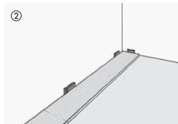
Die Verlegung beginnt in der rechten Raumecke. Das erste Element wird verlegt, **ohne die Klebeschuttfolie zu entfernen** und mit Abstandskeilen an der Wand fixiert. Dabei soll der Dehnungsabstand zur Wand 10–15 mm betragen. Die Elemente werden stets mit der Federseite zur Wand verlegt.
