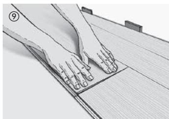
Durch kurzen Druck auf den Querstoß rastet das Element ein und es entsteht eine dauerhafte Verbindung mit der Unterkonstruktion. Falls nötig, kann im Längskantenbereich mit dem Schlagklotz leicht nachgeklopft werden. Unser Tipp: Um die Verbindung zwischen Element und Unterkonstruktion zu stabilisieren, empfehlen wir, nach der Verlegung die Fläche der jeweiligen Reihe zu begehen.
