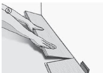
Das letzte Element der ersten Reihe wird auf die benötigte Länge zugeschnitten und eingefügt. Dabei muss ebenfalls der Dehnungsabstand von 10–15 mm zur Wand berücksichtigt werden. In der nächsten Reihe wird mit dem Reststück der ersten Reihe wieder begonnen. Achten Sie jedoch auf einen stirnseitigen Versatz zur vorherigen Reihe von mindestens 50 cm. Durch die Verwendung der Reststücke für die jeweils nächste beginnende Reihe wird der Verschnitt erheblich reduziert.
