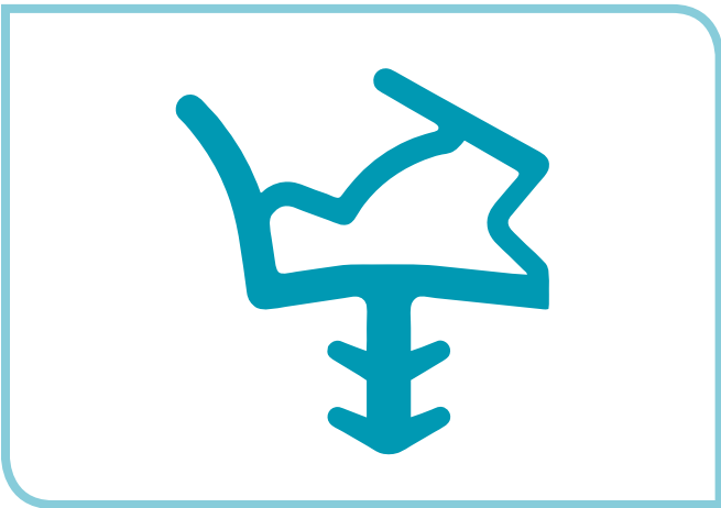
Querschnitt einer originalen Türdichtung (Quelle: Deventer)
