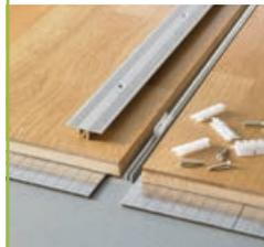
**2** Die Bodenbeläge legen Sie – je nach Schwind- und Ausdehnungsverhalten der Belagsarten – auf Fuge an. Wird eine zusätzliche Erhöhung benötigt, werden die praktischen Erhöhungsteile einfach eingeschoben.
