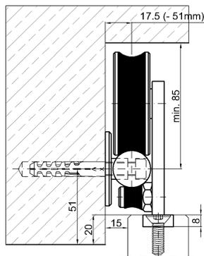
Mindestmaß Mitte Laufschiene bis Unterkante Decke 85mm!
