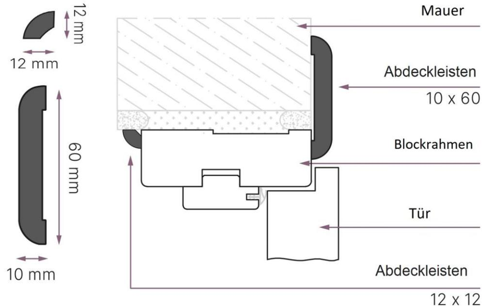
Schneiden Sie die obere Leiste auf einer Seite in einem Winkel von 45 Grad auf die entsprechende Breite zu
