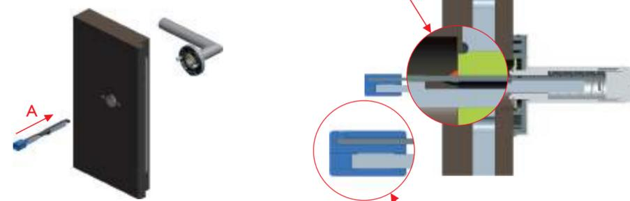
**Achtung:** Der Stift und die Verriegelungszunge müssen vollständig in die **Montageeinheit** eingeschoben sein.
