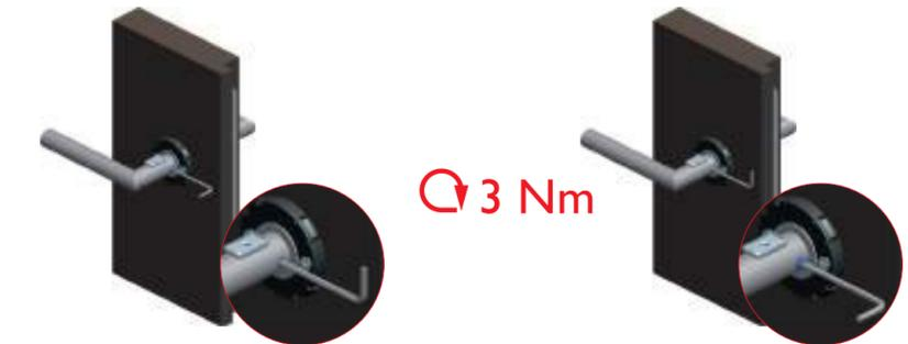
⑦ Bei gelöster Innensechskantschraube wird nun der Schieber bis zum Anschlag zur Tür hin verschoben **A** und die Innensechskantschraube fixiert **B**.
