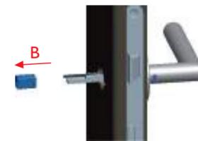
**Achtung:** Dabei kann es passieren, dass die obere Verriegelungszunge leicht aus dem Schloss wieder herausgezogen wird. Diese Zunge muss dann mit dem Montagewerkzeug wieder nach innen geschoben werden bis der Anschlag an der Schlossnuss anliegt.
