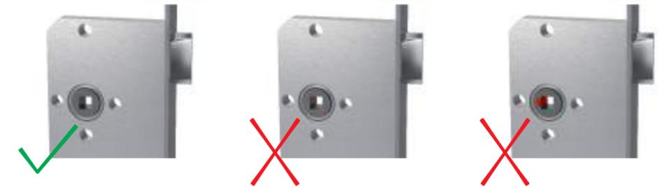
① Nachdem die Rosettenbohrung 7 mm Ø erfolgt ist, kann das Rosettensystem einseitig vormontiert werden.
