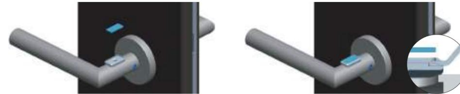
Die Abdeckung lässt sich später wieder über die Einkerbung am Verriegelungsschieber lösen. (Demontagetool liegt der Garnitur nicht bei)
