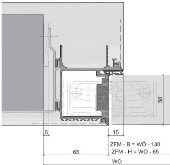
TZS Tapentürzarge für 50 mm Funktionstür mit Brand-, Rauch- oder Schallschutzanforderung
