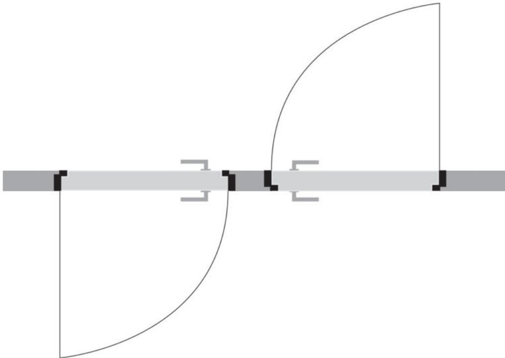
Türelemente bandseitig und bandgegenseitig flächenbündig, bei gleicher Ansichtsbreite der Aluminiumzargen.
